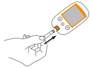
Inserte la tira reactiva en el medidor (en la dirección de la flecha) hasta que éste emita un pitido.
